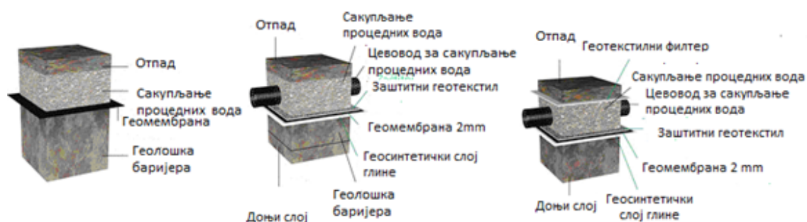
Слика 6.46. Приказ доњих слојева депоније
