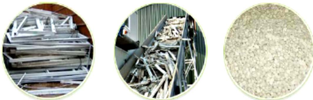
Слика 6.20. Добијање гранулата од ПВЦ прозора
